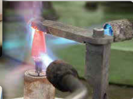
Le procédé de brasage The brazing process
