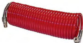
COUVERT: Élastomère en nylon rouge, résistant aux huiles, fluides hydrauliques et de nombreux contaminants. Rétractabilité 30 à 1. Pour obtenir la longueur de tuyaux prolongée requise, multiplier la distance nécessaire par 1.3
